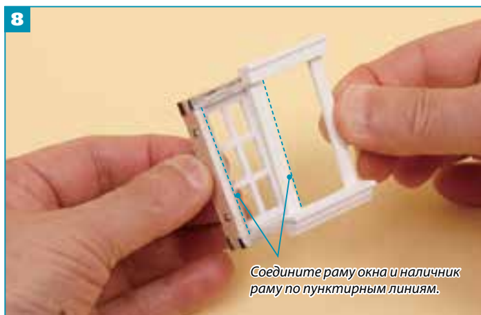
8 При помощи секундного клея соедините раму из шага 6 и наличник из шага 7.
